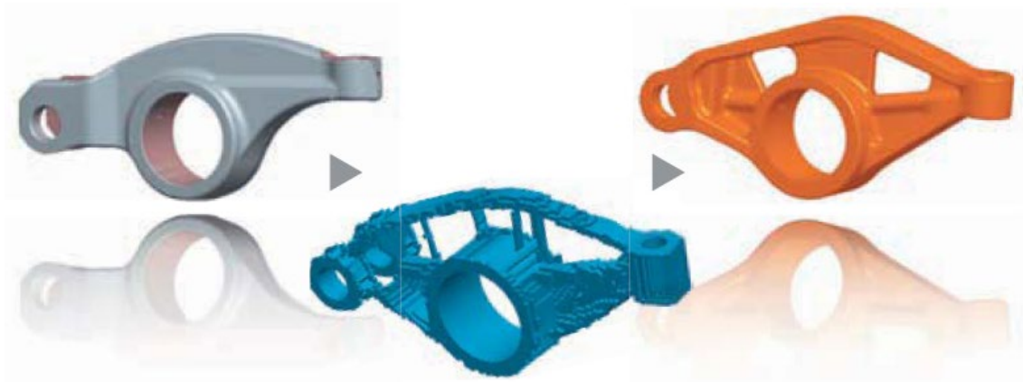
Abb. 120 Optimierter Kipphebel mit Massenreduktion von 35%
