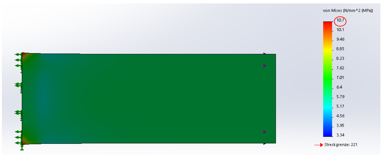
Abb. 24 Simuliertes Bauteil mit einer maximalen Von-Mises-Spannung von 10,7 N/mm 2
